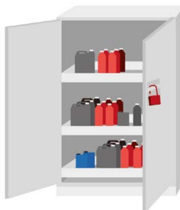
Figur 2. Kemikalieförråd med hyllor i form av spilltråg
