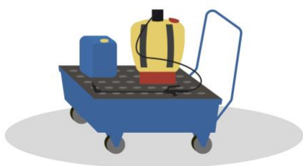
Illustration 38. Illustration visar en kemikalievagn med tråg, galler och hjul.
