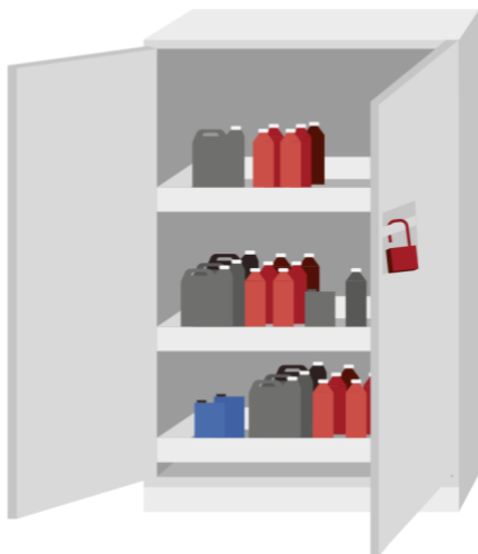
Illustration 34. Illustrationen visar ett kemikalieskåp med låsbara dörrar, och som har hyllor som är formade som tråg, med högre kanter för stora förpackningar och lägre kanter för mindre förpackningar.
